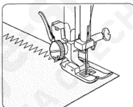
Jednoduché stehování pomocí zigzag stehu je velmi používané pro obrubování, entlování, šití knoflíků, apod.
