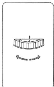
Nastavte požadovanou hodnotu na kolečku pro nastavené napětí horní nitě.
