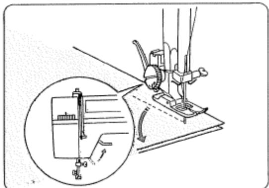
Zastavte stroj a otočte ručním kolem směrem k sobě pro zapíchnutí jehly do látky.
