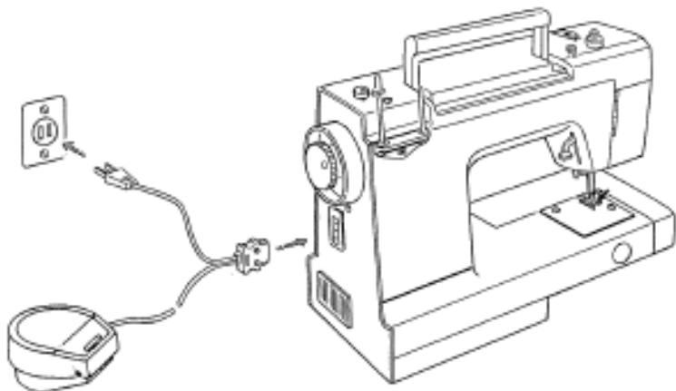
Před zapojením šicího stroje do sítě se ujistěte, že je stroj určen pro vaši elektrickou síť.
