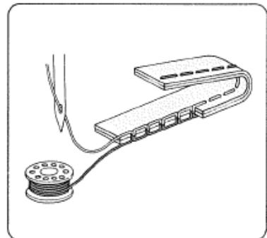
Horní a spodní nit by se měla provazovat uprostřed, mezi dvěma vrstvami látek v rovném švu.
