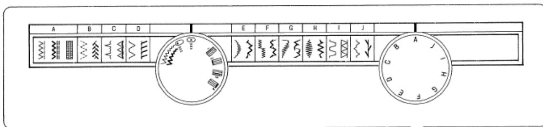
Kolečko pro nastavení šířky zigzag stehu slouží jak pro nastavení šířky zigzag stehu, tak pro nastavení centrální a levé pozice jehly pro rovný steh a trojitý zesílený steh a také pro šití knoflíkových dírek.
