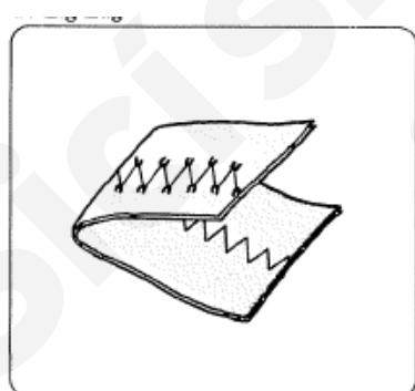
Pro nastavení lepšího zigzag stehu – by mělo být napětí horní nitě poněkud nižší, než v případě, kdy šijete rovným stehem. Horní nit by se měla trošku objevovat na rubové straně látky.
