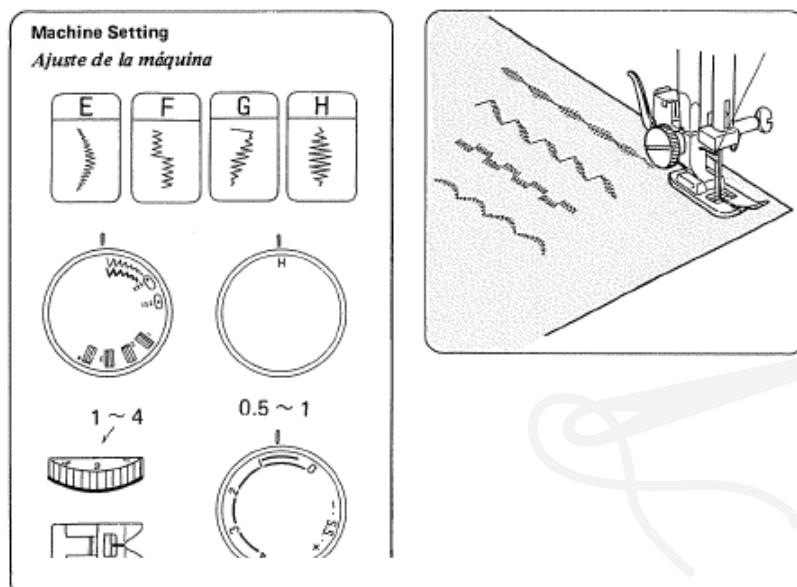
Ušijte řadu stehů a nastavte napětí nitě tak, aby se horní nit objevovala na opačné straně látky. Pro nejlepší výsledek vyzkoušejte nejdříve na testovací kousek látky.
