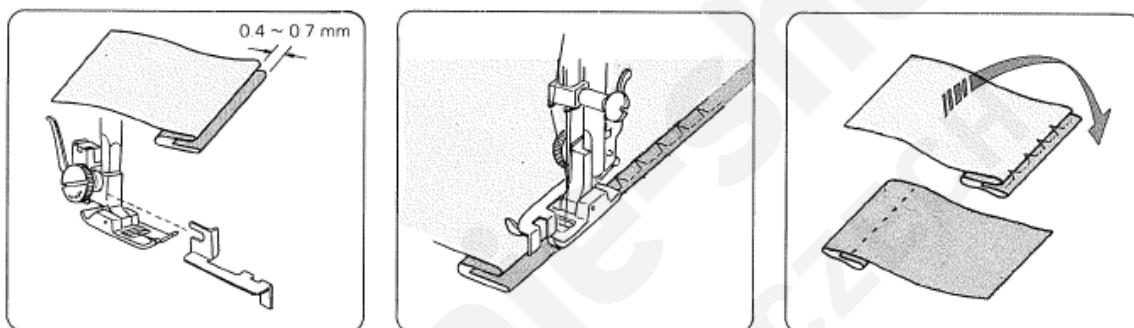
Přeložte požadovanou část a sešpendlete. Poté přeložte lem pod látku – viz obrázek. Spusťte přítlačnou patku, poté uvolněte šroubek držáku patky a mezi šroubek mezi šroubek a držák patky umístěte vodič lemu. Utáhněte šroubek a ujistěte se, že ohraničení vodiče lemu je umístěte uprostřed mezi výstupky přítlačné patky.
