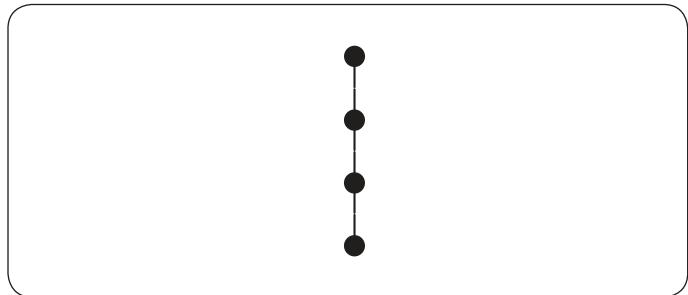
Zvyšte napětí horní nitě na hodnotu 5–8.
