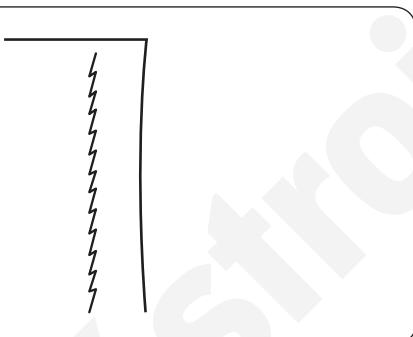
Tento úzký strečový steh s jehlou v levé poloze je navržen tak, aby předcházel krčení úpletových látek a šikmých švů, zatímco umožňuje plné rozžehlení švu.
