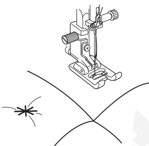
Spojit jednotlivé vrstvy quiltu můžete velmi jednoduše s použitím svorkového stehu. Zvolte vzor stehu 43 (mód 2).
