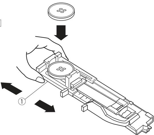
Velikost knoflíkové dírky je automaticky stanovena vložením knoflíku do zadní části automatické knoflíkové patky R. Držák knoflíků na patce pojme knoflík o velikosti 1 cm (3/8") až 2.5 cm (1") v průměru. Při volbě knoflíkové dírky se na LCD obrazovce objeví doporučení pro spuštění knoflíkové páčky.
