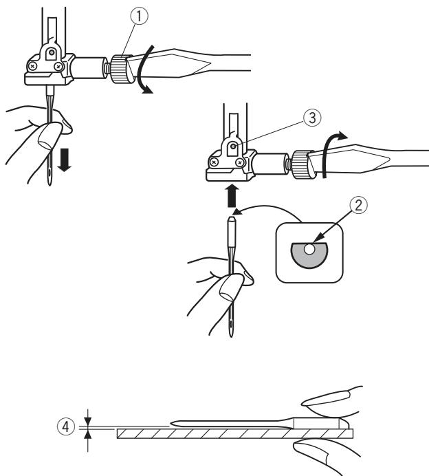
Zdvihněte jehlu stisknutím tlačítka jehla nahoře/dole a spusťte přítlačnou patku. Vypněte hlavní vypínač stroje.
