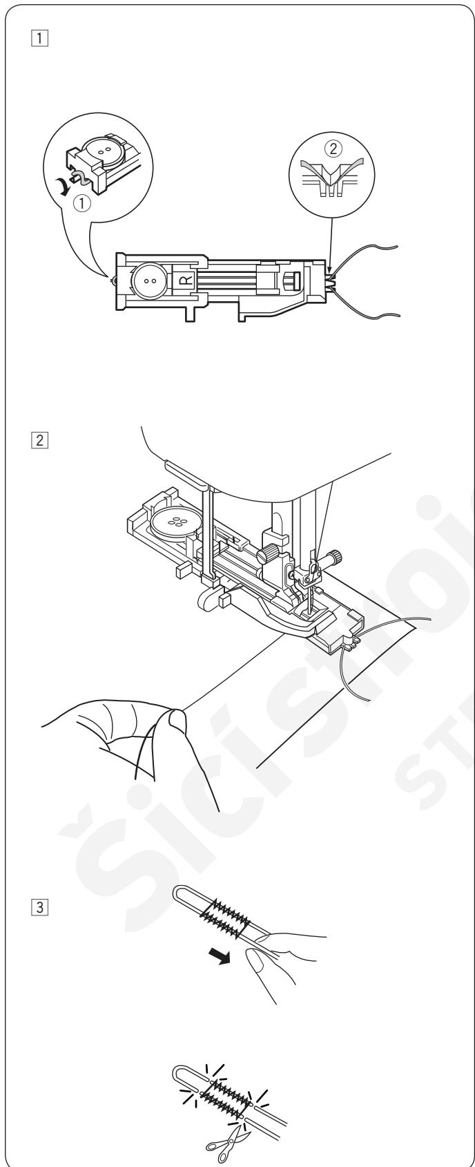
1 Postupujte stejně jako při šití čverhranné knoflíkové dírky. Nastavte šířku stehu tak, aby odpovídala tloušťce použitého kordu. Se zdviženou knoflíkovou patkou zahákněte kord za výčnělek ① v zadní části knoflíkové patky. Vytáhněte konce směrem k sobě pod patkou, ponechejte volnou přední část před patkou. Zahákněte kord do vidliček ② ve přední části automatické knoflíkové patky pro jejich pevné zafixování. Spusťte jehlu do látky do bodu, odkud chcete začít šít.
