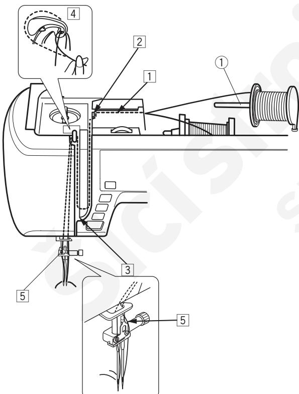
Zasuňte přídavný kolíček na špulku do otvoru vedle horizontálního kolíčku na špulku.
