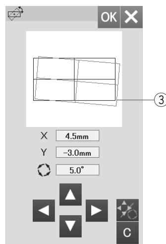
Červený obdélník ③ se objeví, jakmile provedete jemné úpravy ve výšivce a ukáže rozdíl mezi původní polohou a novou upravenou polohou výšivky.
