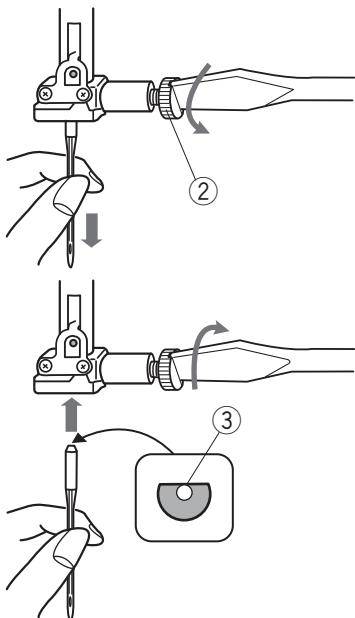
Zdvihněte jehlu otáčením ručního kola. Vypněte hlavní vypínač stroje nebo stiskněte zamykací tlačítko.
