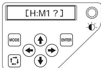
8 Na LCD displeji se zobrazí upozornění o potvrzení typu použitého rámečku.
