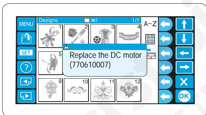
Jestliže celková doba používání DC motoru dosáhne 1000 hodin, zobrazí se zpráva doporučující výměnu DC motoru.
