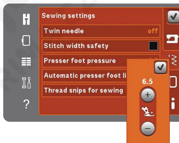
Ovládání přítlaku přítlačné patky
