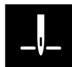
Poloha jehly při zastavení stroje
